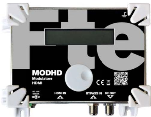
Il MODHD è un modulatore digitale di alta qualità in grado di gestire il segnale di una sorgente A/V in alta definizione con uscita HDMI. Il segnale viene digitalizzato, codificato in H.264/AVC (MPEG4) e modulato su un canale DVB-T in uscita.
